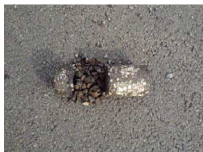
Próbka z odwiertu – odmyte, luźne ziarna
